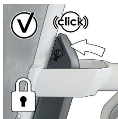
Abbildung 18 : Klickgeräusch signalisiert ordnungsgemäß eingesetzten Akku
